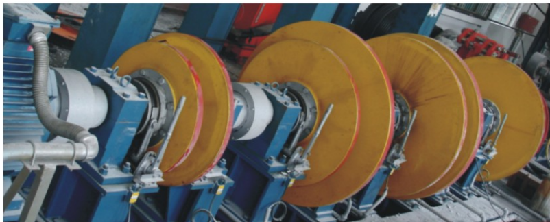
制动盘/轮系统测试台
