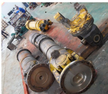
进口万向节到公司维修
