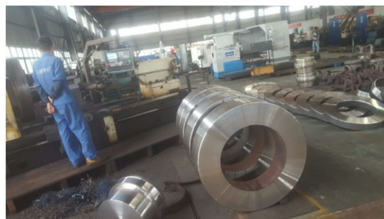
正在加工的大型胀套
