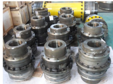
氮化后的齿轮联轴器
