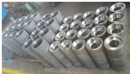
带扭矩限制的同步带轮（发明专利）
