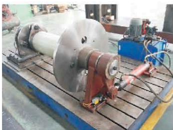
风电膜片联轴器静态测试
