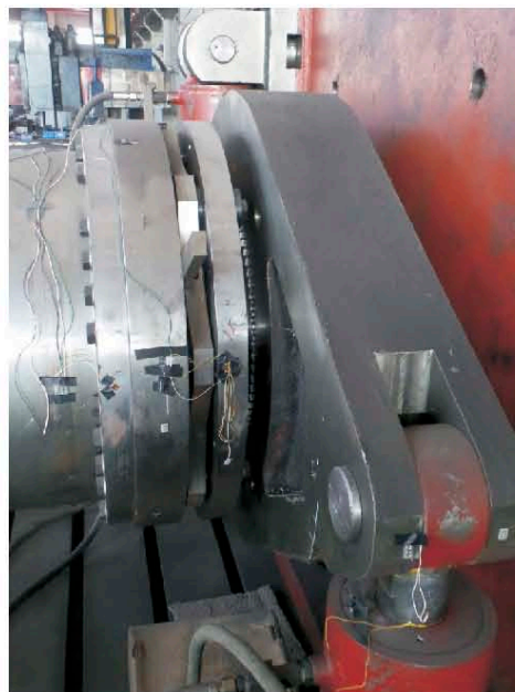
大型膜片联轴器扭矩、刚度测试
