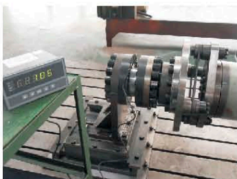
风电膜片联轴器过载测试
