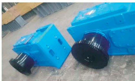
蛇形弹簧联轴器(半边安装在减速机轴上)
