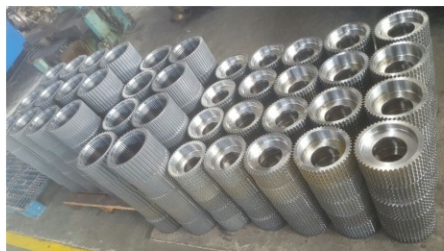
带扭矩限制的同步带轮（发明专利）
