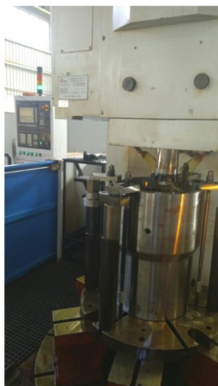
高位数控插齿机 (M20模数/高度1250mm)
