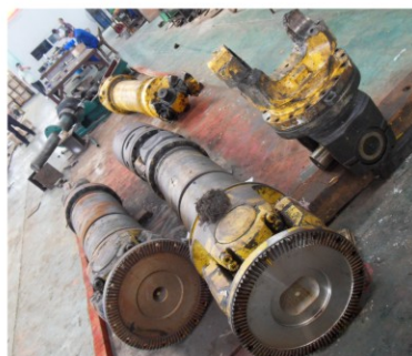
进口万向节到公司维修
